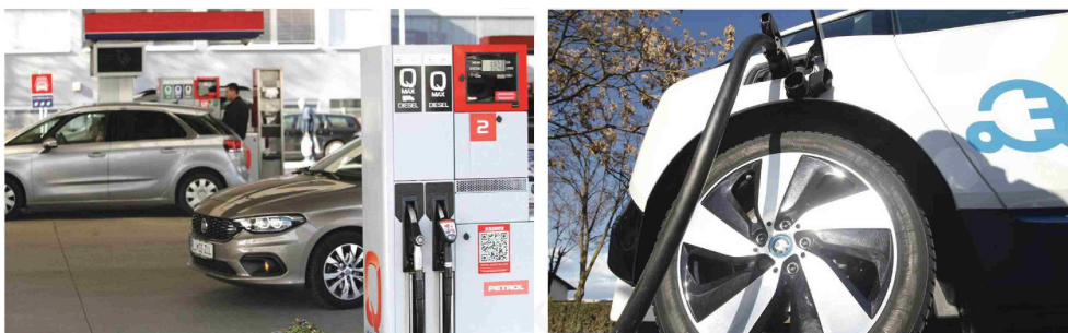
V vozilu z motorjem z notranjim zgorevanjem damo v posodo energijo v obliki tekočega goriva (levo), v baterijskem avtomobilu (desno) pa električno energijo. Izkoristek električnega vozila od polnitve do koles je precej boljši, je pa izkoristek pridobivanja električne energije slabši kot izkoristek pri pridobivanju tekočega goriva. FOTOGRAFIJI MAVRIC PIVK
